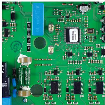
**Diese Frequenzumrichter der A.S.T. Leistungselektronik Berlin sind nach EN 50155 speziell für den Einsatz in Bahnfahrzeugen entwickelt.**
